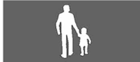
Kuva: Jalankulkuliikenteelle tarkoitettu tienosa (finlex.fi)
